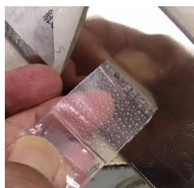
図.HP-EP-1 SUS板剥離状態（糊残り無）
